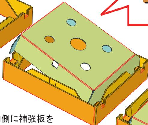
5 内フラップを折り上げて、その内側に補強板を差し込みます。
