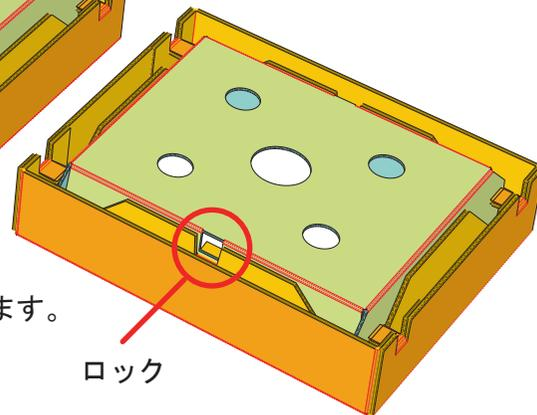
6 フレームと補強板をロックします。
